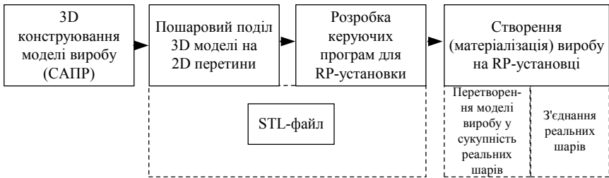
Рисунок 3 – Функціональна схема технологій прискореного формоутворення
