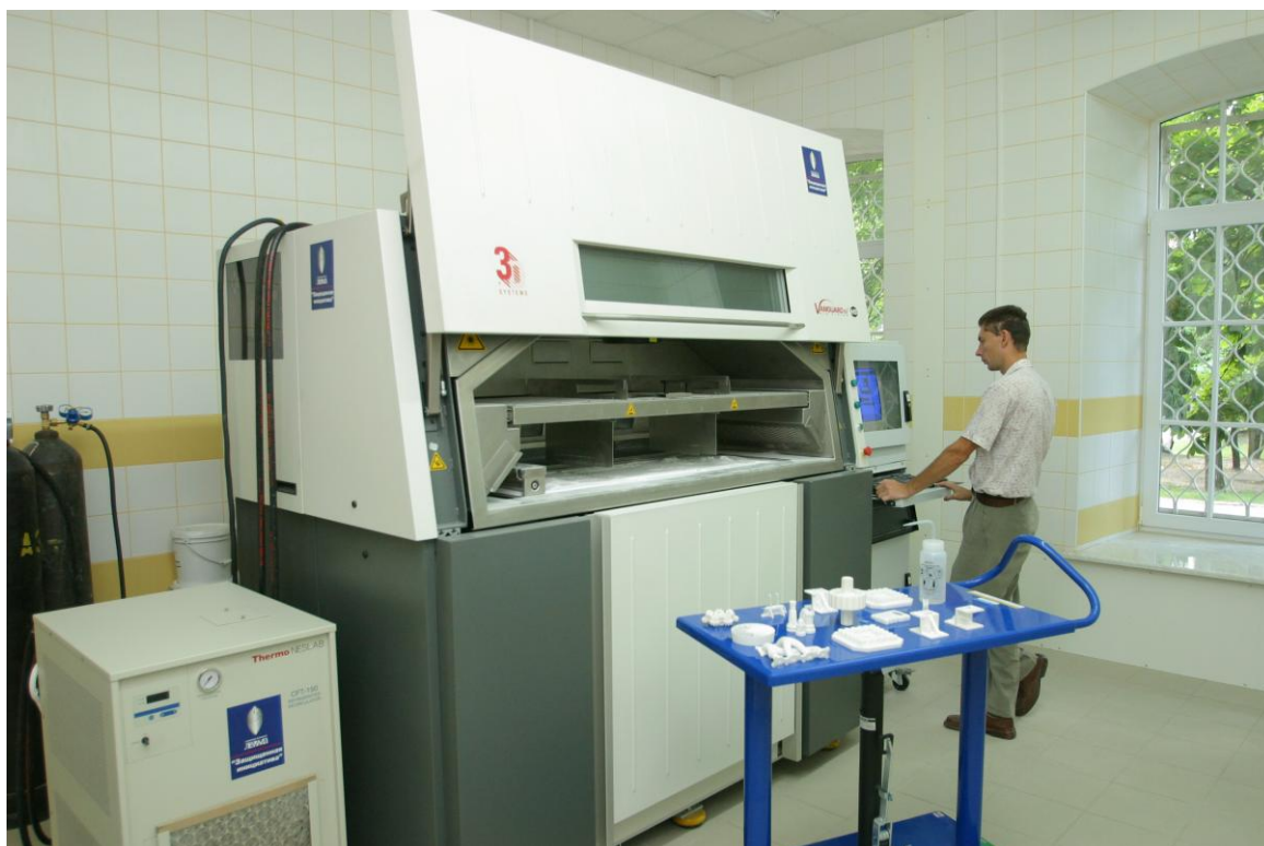
Рисунок 3.21 – Система избирательного лазерного спекания на базе установки Vanguard Si 2 SLS
