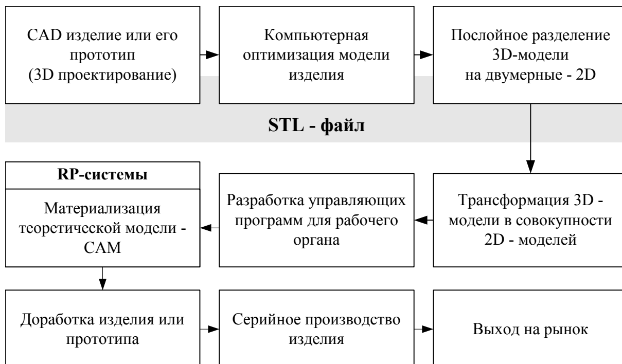
Рисунок 3.2 – Структура интегрированного рабочего процесса ускоренного формообразования – Rapid Prototyping
