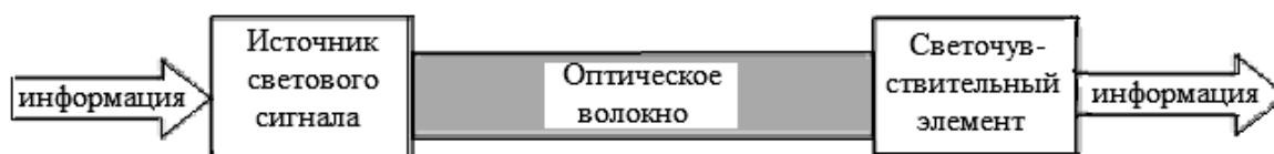
Рисунок 7.23 – Схема волоконно-оптической линии связи
