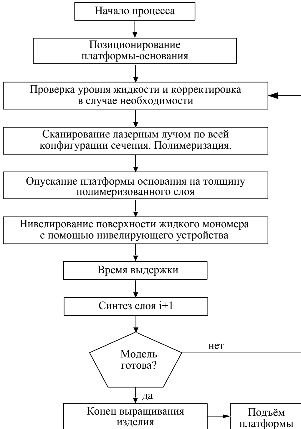
Рисунок 3. 8 – Схема процесса лазерной стереолитографии
