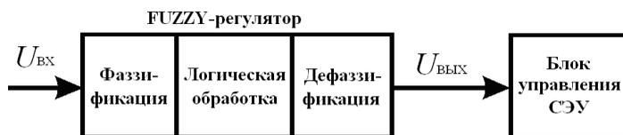
Рисунок 7.10 – Этапы обработки сигнала фаззи-регулятора
