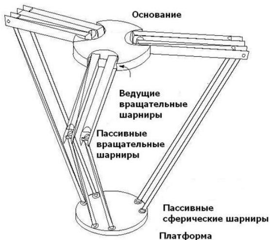
Рисунок 3.42 – Схема дельта-механизма
