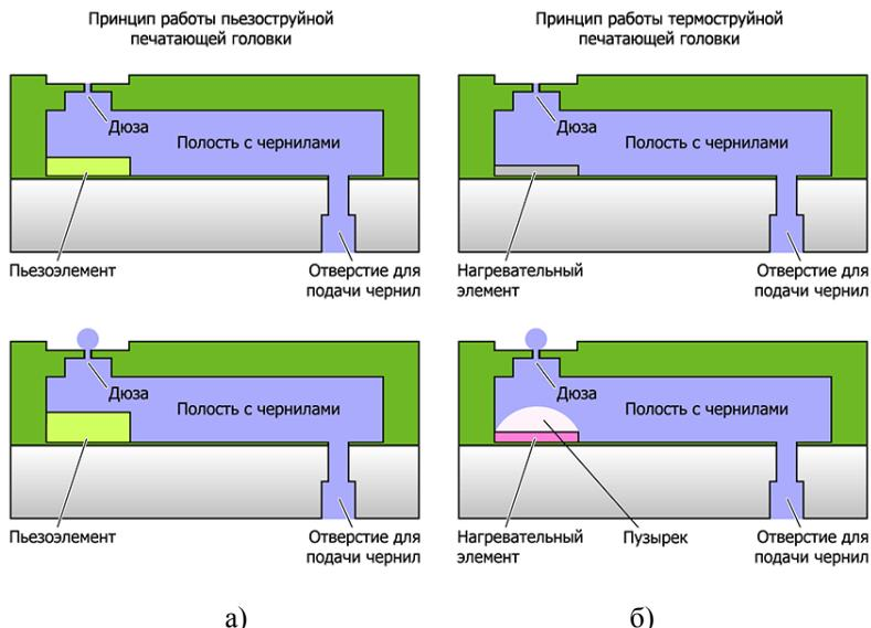
Рисунок 5.44 – Конструкции печатающих головок струйных принтеров
