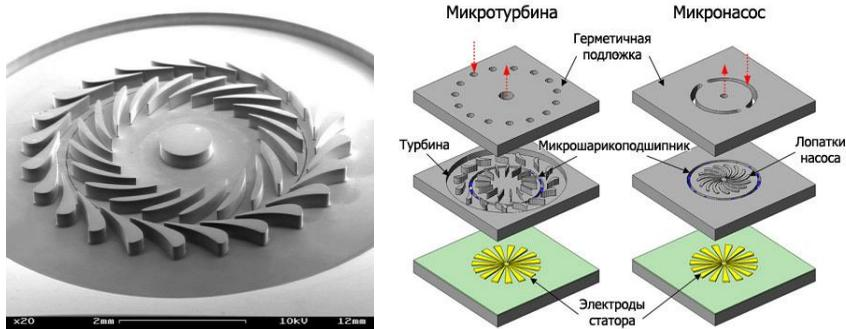
Рисунок 5.45 – Микротурбина и микронасос
