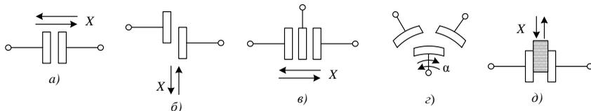
Рисунок 6.4 – Емкостные датчики
