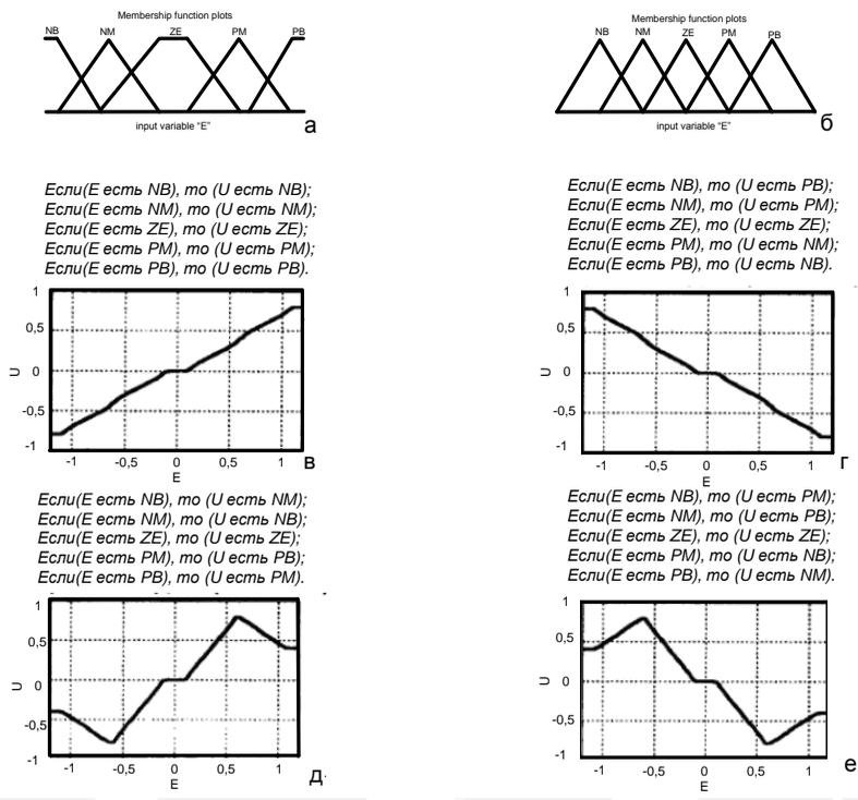
Рисунок 7.21 – Выходные характеристики фаззи-регулятора при изменении базы правил
