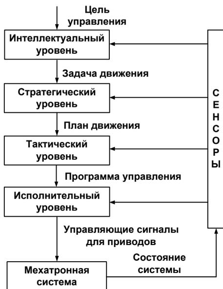
Рисунок 7.3 – Иерархия управления в мехатронных системах
