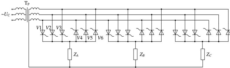
Рисунок 5.25 – Схема ПЧ с непосредственной связью с питающей сетью
