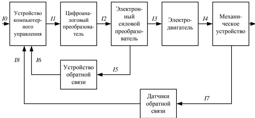
Рисунок 4.8 – Структура традиционного электропривода с компьютерным управлением
