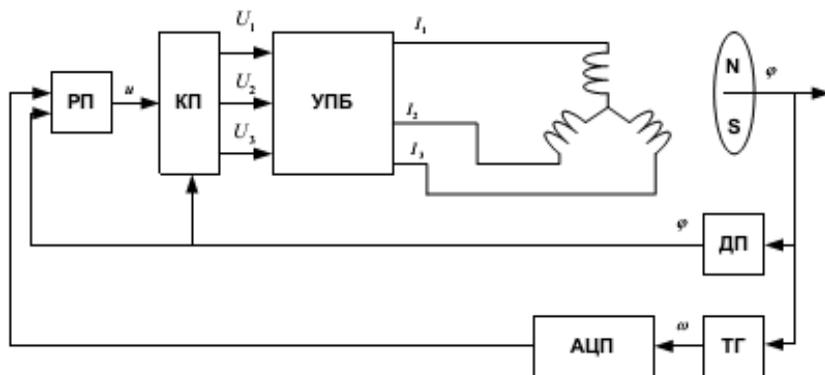
УПБ – усилительно-преобразовательный блок; КП – координатный преобразователь; РП – регулятор положения
