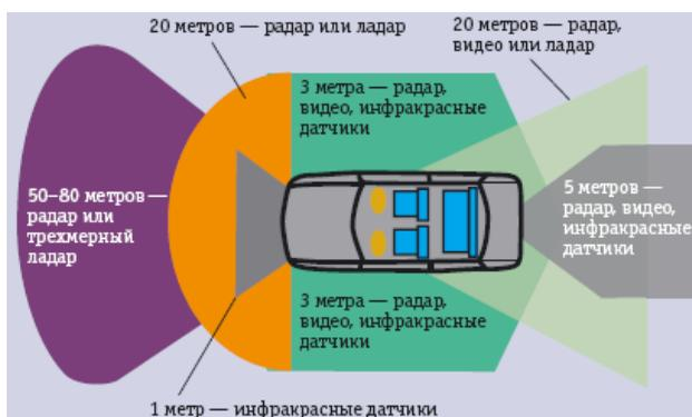
Рисунок 3.13 – Датчики ориентации в пространстве и дистанция их действия
