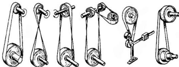
Рисунок 5.8 – Передачи с гибкой связью
