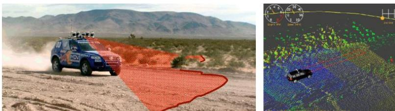
Рисунок 3.14 – Иллюстрация лазерного сенсора
