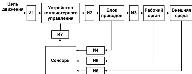
Рисунок 7.1 – Функциональная схема устройства с компьютерным управлением
