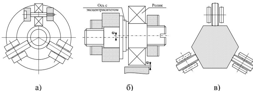
Рисунок 5.11 – Направляющие с трением качения открытого типа
