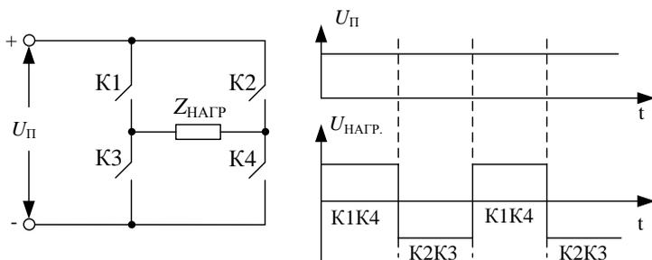
Рисунок 5.24 – Схема инвертора и временные диаграммы
