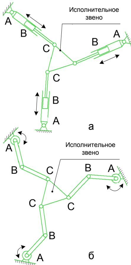
*a* – манипулятор с параллельно действующими линейными двигателями;
