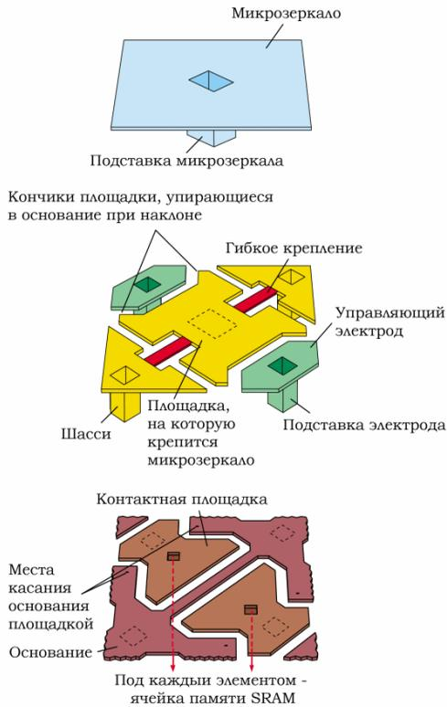
Рисунок 5.42 – Конструкция микрозеркального устройства
