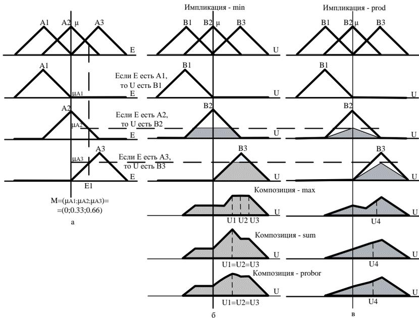
Рисунок 7.14 – Процесс обработки входного сигнала в фаззи-регуляторе
