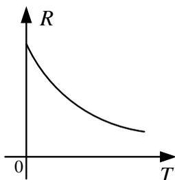
Рисунок 6.15 – Температурная характеристика  $R(T)$  терморезистора
