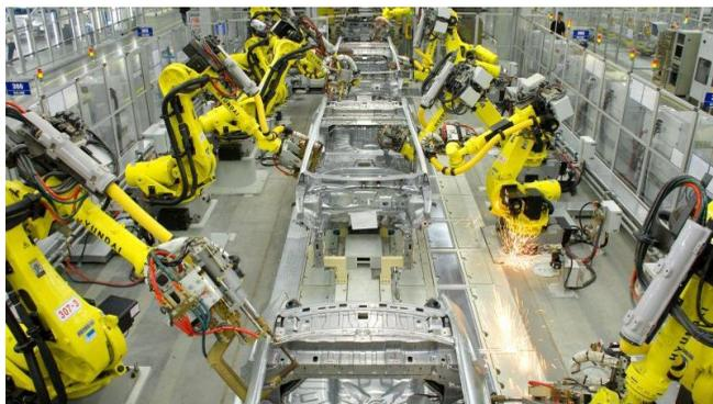
Рисунок 3.4 – Сварочный цех по сборке автомобильных кузовов
