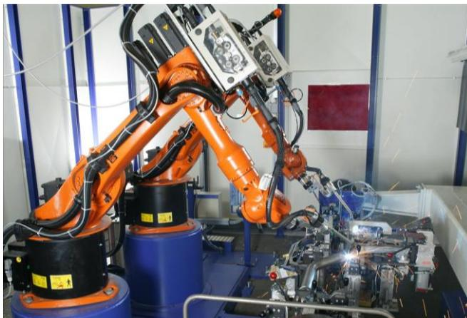
Рисунок 3.5 – Выполнение роботом операции сварки
