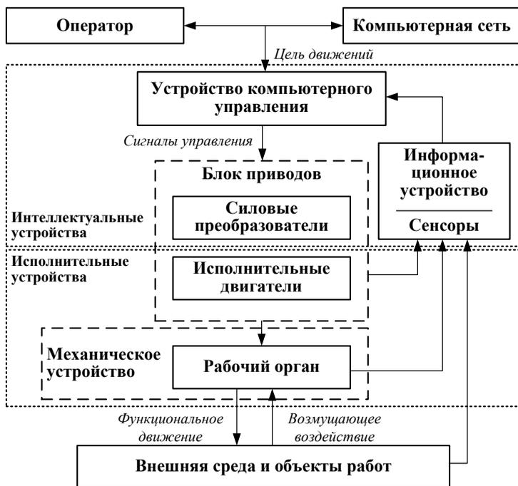
Рисунок 2.2 – Обобщенная схема машины с компьютерным управлением движением
