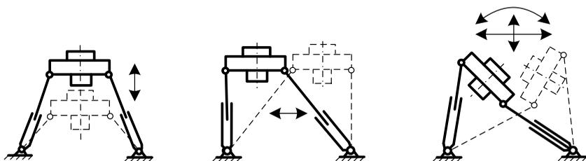
Рисунок 3.45 – Возможные положения рабочей головки станка-гексапода
