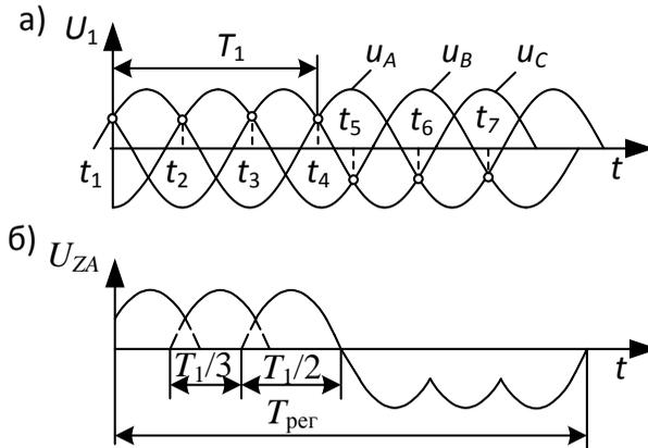
Рисунок 5.26 – Графики напряжений сети (а) и на выходе ПЧ (б)
