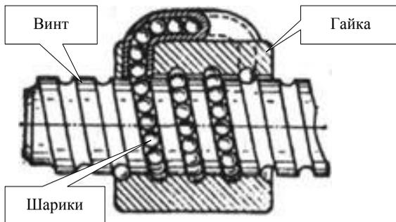
Рисунок 5.5 – Винтовая шариковая пара
