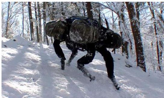
Рисунок 3.26 – Робот Big Dog на пересеченной местности
