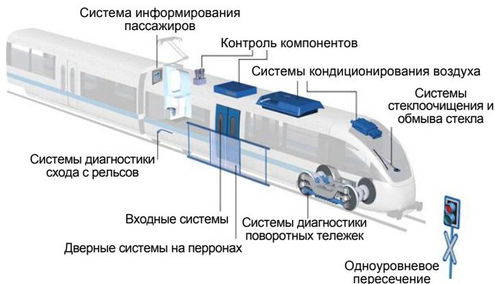
Рисунок 3.16 – Системы диагностики схода с рельсов, системы диагностики поворотных тележек, системы кондиционирования воздуха, входные системы и дверные системы на перронах, системы стеклоочистителя и обмыва стекла, система информирования пассажиров.
