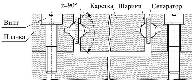
Рисунок 5.10 – Направляющие с трением качения закрытого типа
