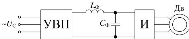
УВП – управляемый вентильный преобразователь, И – инвертор, Дв – двигатель переменного тока,  $L_{\Phi}$ ,  $C_{\Phi}$  – индуктивно-емкостной фильтр
