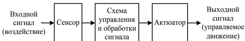
Рисунок 5.37 – Общая структура микромехатронного устройства
