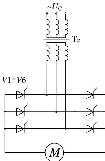
Рисунок 5.21 – Вентильный преобразователь
