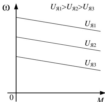
Рисунок 5.17 – Механические характеристики
