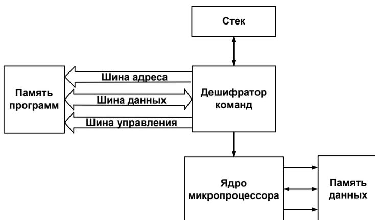
Рисунок 5.29 – Микропроцессорная система с гарвардской архитектурой
