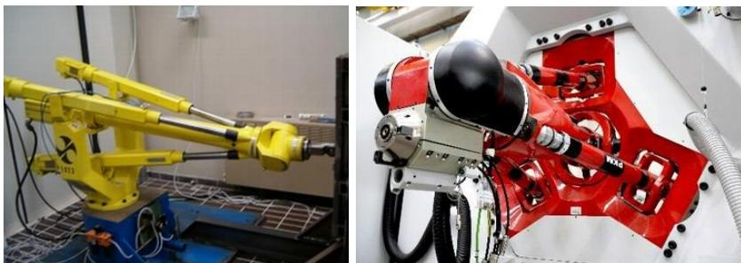
Рисунок 3.43 – Промышленные роботы линейки Tricept
