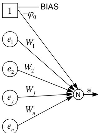
Рисунок 7.24 – Схема нейрона
