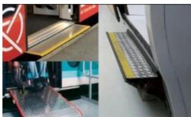
Рисунок 3.18 – Рампы, откидные и раздвижные подножки
