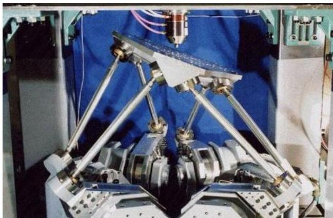
Рисунок 3.41 – Шести координатный поворотный стол по схеме «ротопод»
