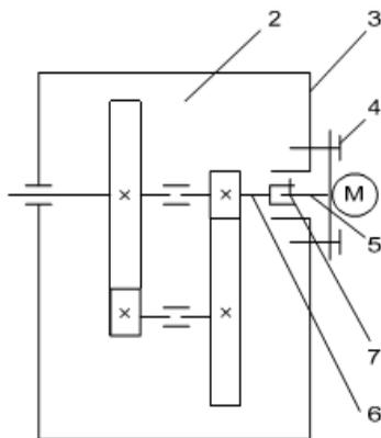
Рисунок 5.30 – Цилиндрический мотор-редуктор
