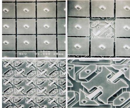
Рисунок 5.41 – Фрагмент матрицы микрозеркал
