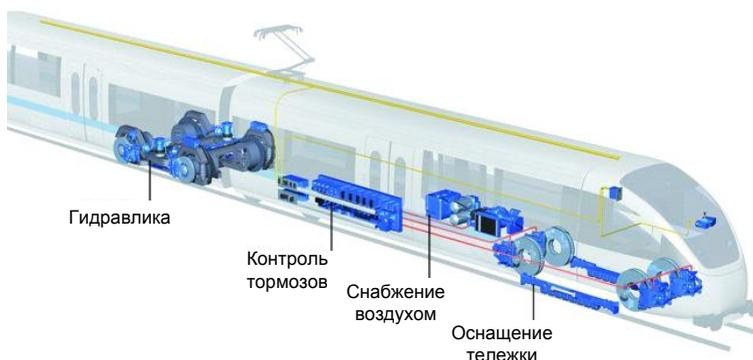
Рисунок 3.15 – Тормозная система поезда
