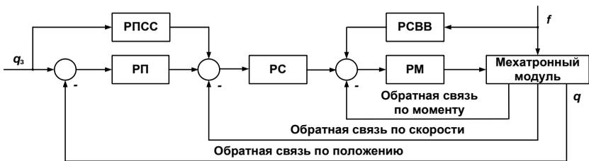
Рисунок 7.5 – Функциональная схема системы управления на исполнительном уровне
