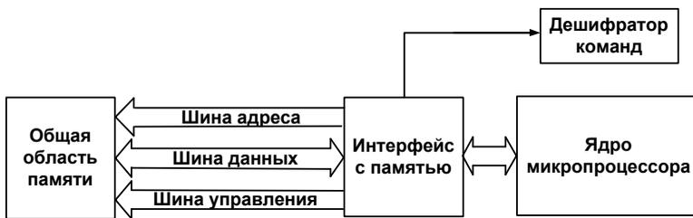
Рисунок 5.28 – Микропроцессорная система с неймановской архитектурой
