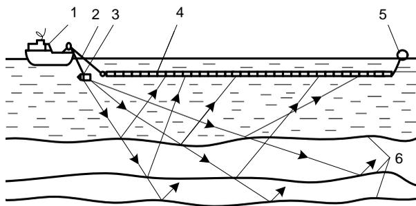
Рисунок 3.23 – Схема проведения геофизических исследований
