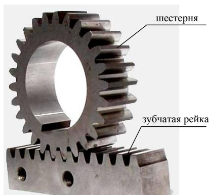
Рисунок 5.2 – Реечная передача
