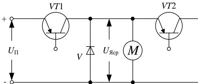
Рисунок 5.22 – Схема ШИП
