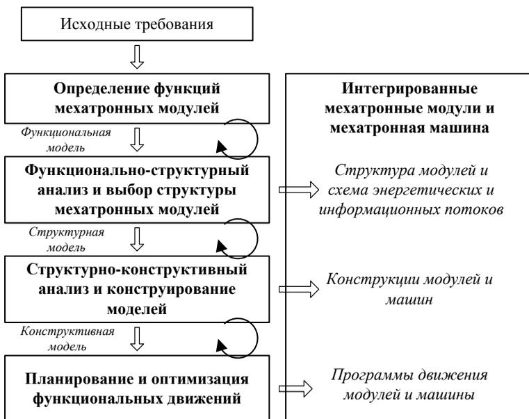
Рисунок 4.5 – Процедура проектирования интегрированных мехатронных машин
