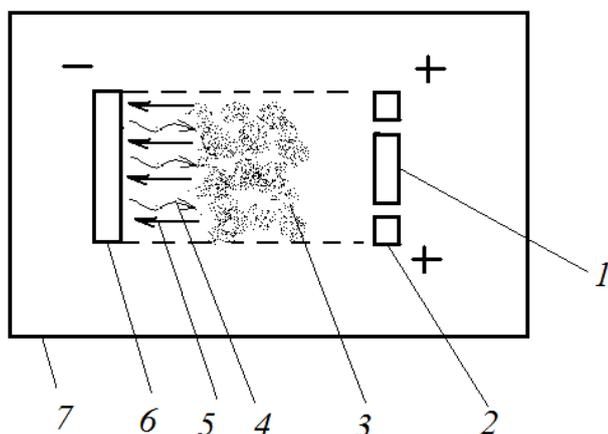
Рисунок 7.14 – Упрощенная схема установки катодного распыления
