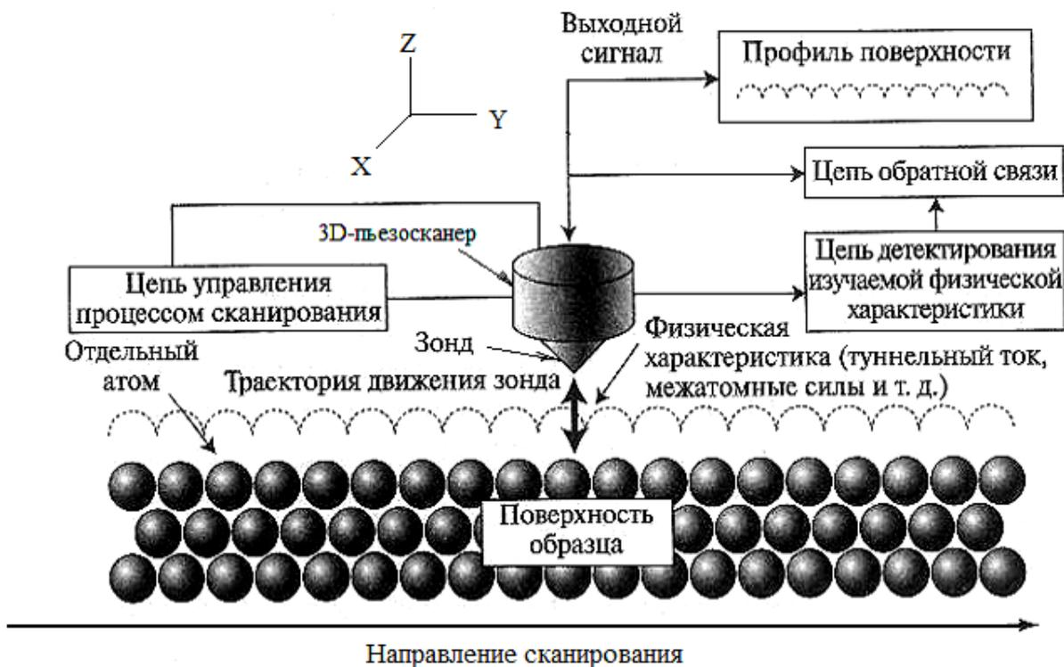
Рисунок 2.5 – Типовая схема зондовых сканирующих микроскопов
