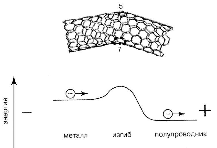
Рисунок 8.7 – Влияние изгиба углеродной нанотрубки на энергию подвижных электронов (электропроводность)
