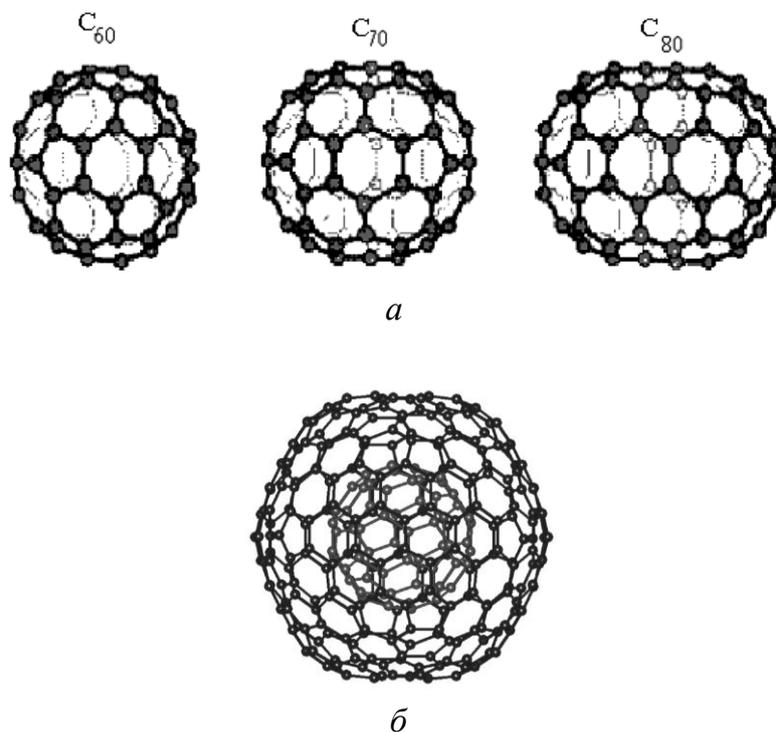
Рисунок 6.3 –Примеры структур на основе углеродных кластеров:
