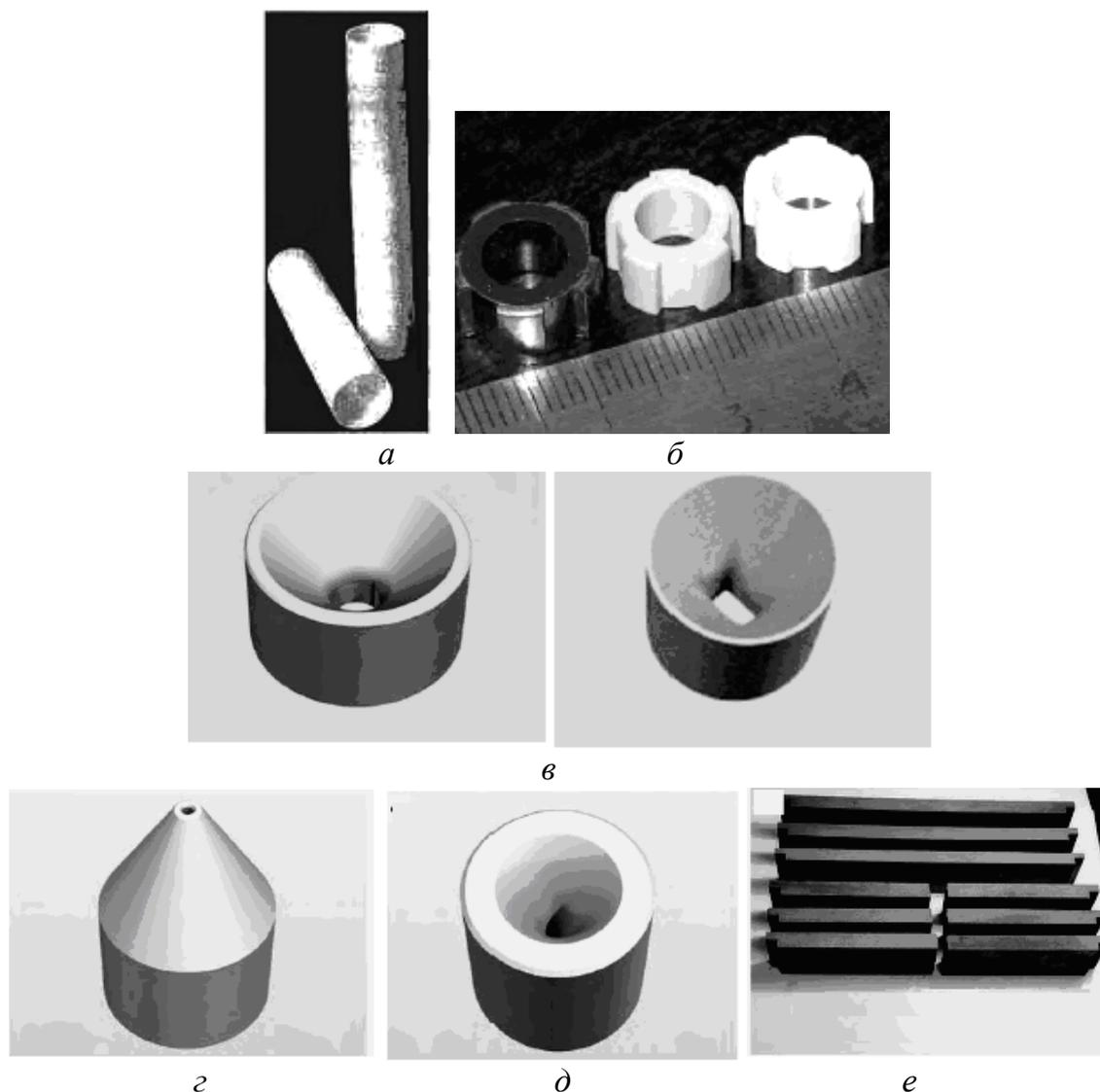
Рисунок 8.3 – Керамические изделия с наноструктурой, полученные компактированием нанопорошков:
