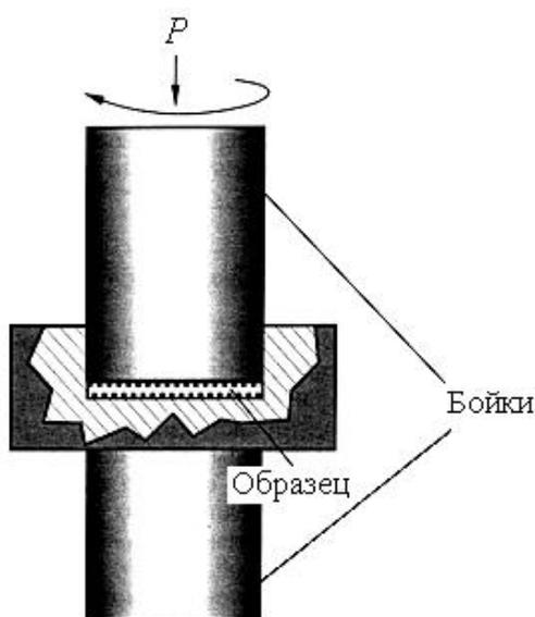
Рисунок 7.4 – Схема метода кручения под давлением
