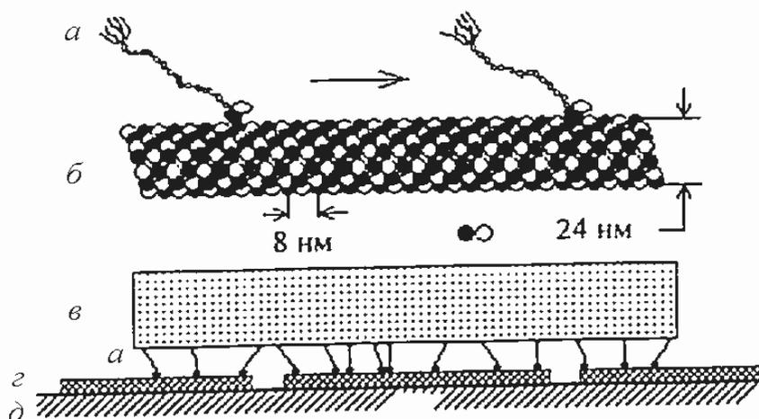
Рисунок 6.20 – Протеиновая нанотрубка (б) в качестве шагового двигателя с кинезинами (а), питающими биоэнергией микрочип (в), который катится по нано-трубкам (z), распределенным на поверхности (д)
