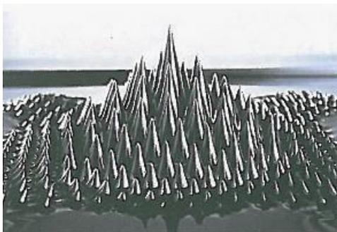
Рисунок 8.5 – Магнитная жидкость, помещенная в магнитное поле
