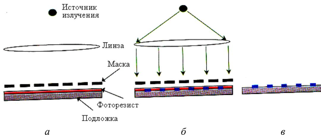
Рисунок 3.18 – Принципиальная схема литографии
