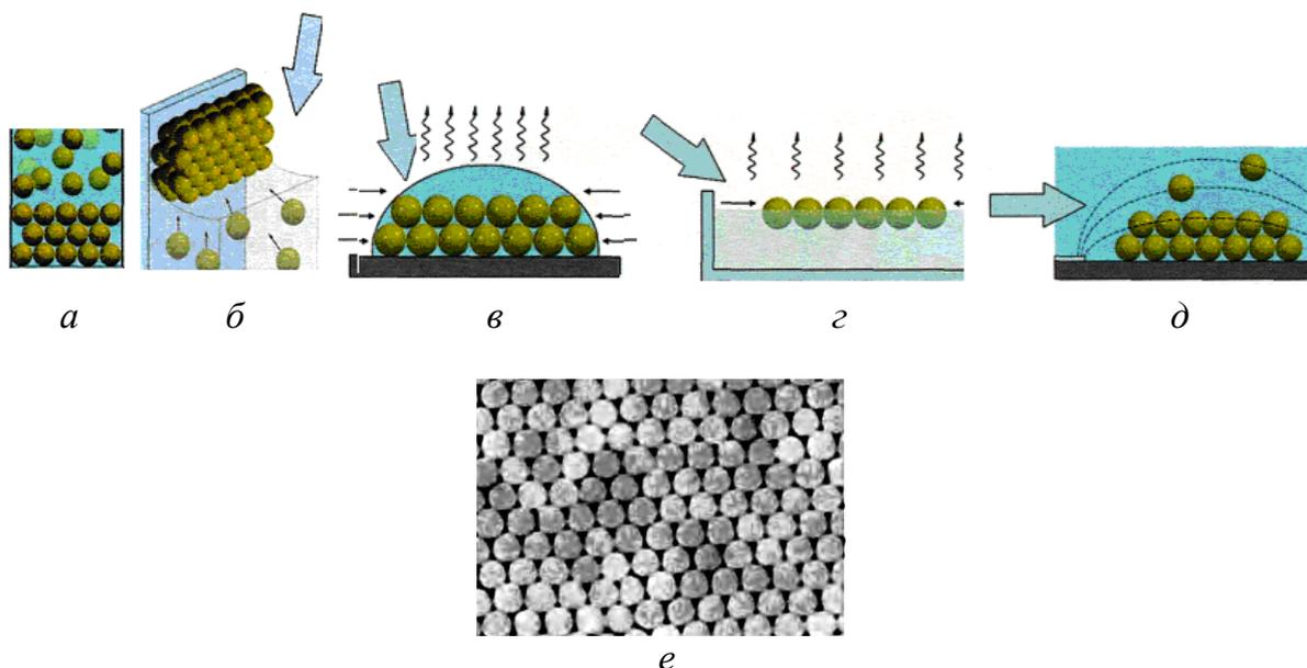
Рисунок 3.6 – Самосборка под действием гравитационного поля (*a*), капиллярных сил (*б*), сил поверхностного натяжения (*в,г*), электрического поля (*д*); *e* – упорядоченная структура, полученная самосборкой
