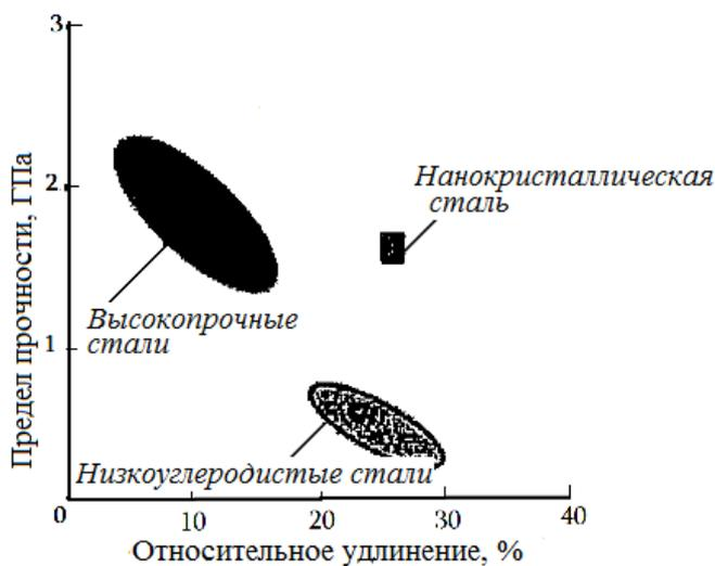
Рисунок 4.11 – Соотношение между прочностью и пластичностью для сталей
