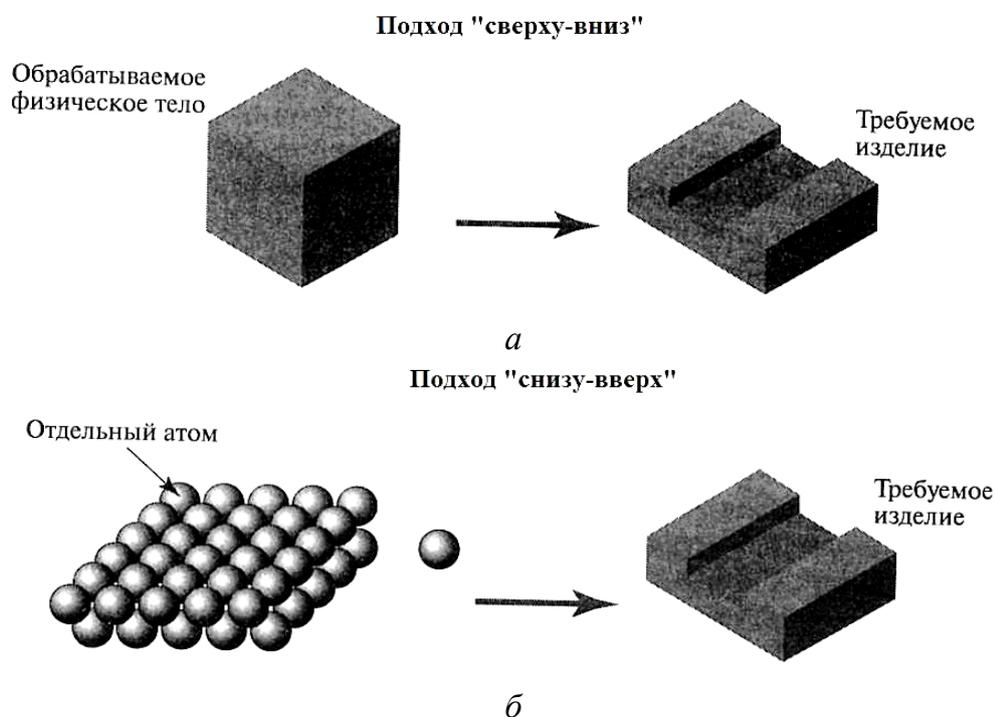
Рисунок 3.1 – Подходы наномонтажа для получения требуемого изделия: *a* – «сверху-вниз» с последовательным уменьшением размеров до требуемых; *б* – «снизу-вверх» путем сборки на атомарном уровне
