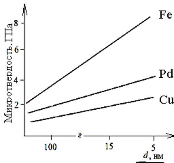
Рисунок 4.9 – Влияние размера зерна на микротвердость материалов
