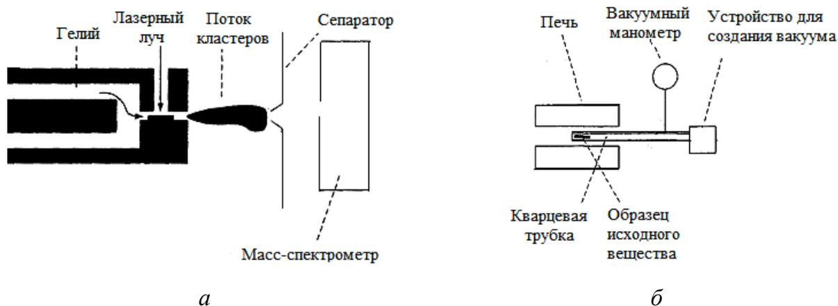
Рисунок 3.13 – Схемы установок для получения металлических атомных кластеров:
