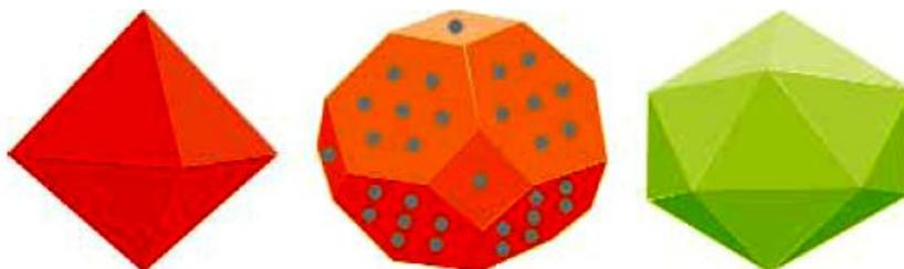
Рисунок 3.9 – Возможные формы металлических наночастиц
