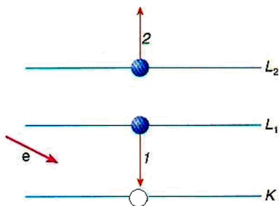
Рисунок 2.12 – Схематическое изображение формирования оже-электрона
