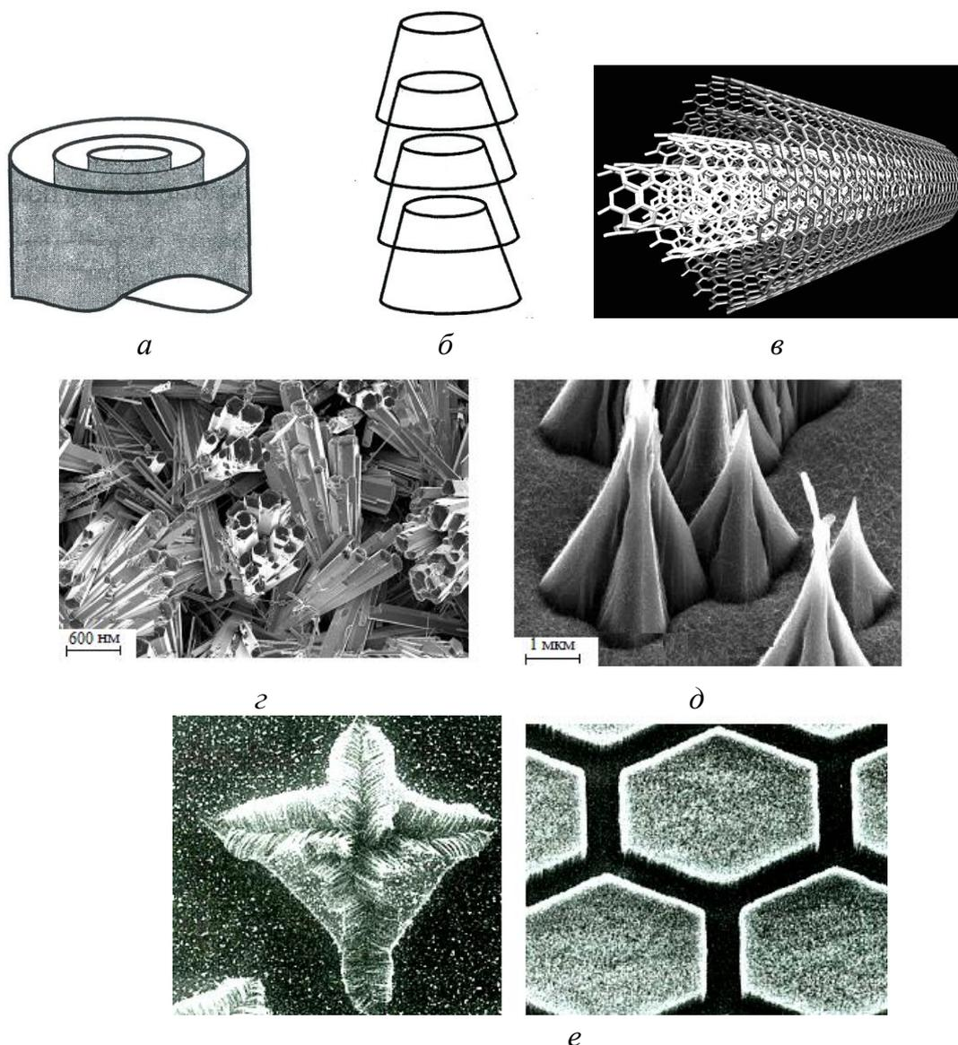
Рисунок 6.13 – Примеры структур на основе углеродных нанотрубок:
