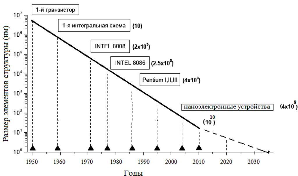
Рисунок 8.8 – Динамика уменьшения размеров элементов интегральных схем (в скобках указано число транзисторов)
