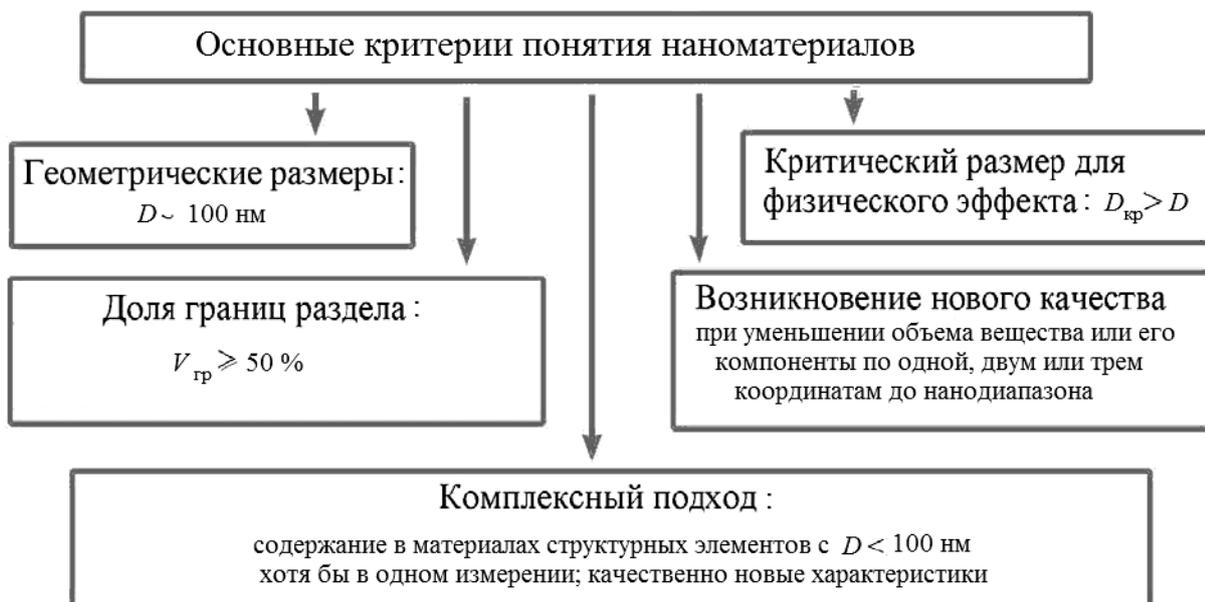
Рисунок 4.5 – Основные критерии, определяющие наноструктурное состояние
