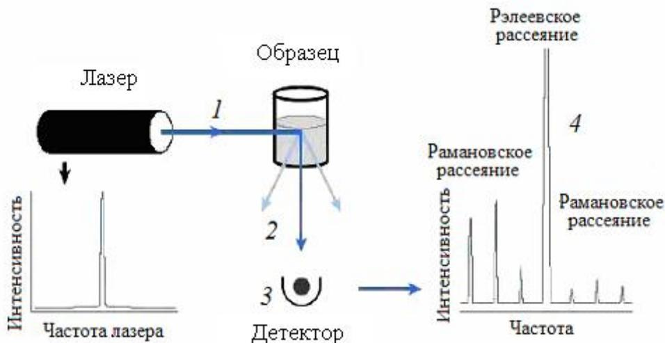
Рисунок 2.14 – Схема исследования с помощью рамановской спектроскопии:
