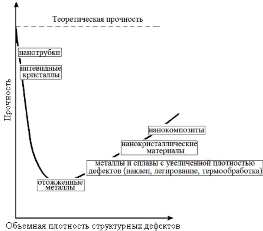
Рисунок 4.8 – Схематическая зависимость прочности от плотности атомарных дефектов в материале
