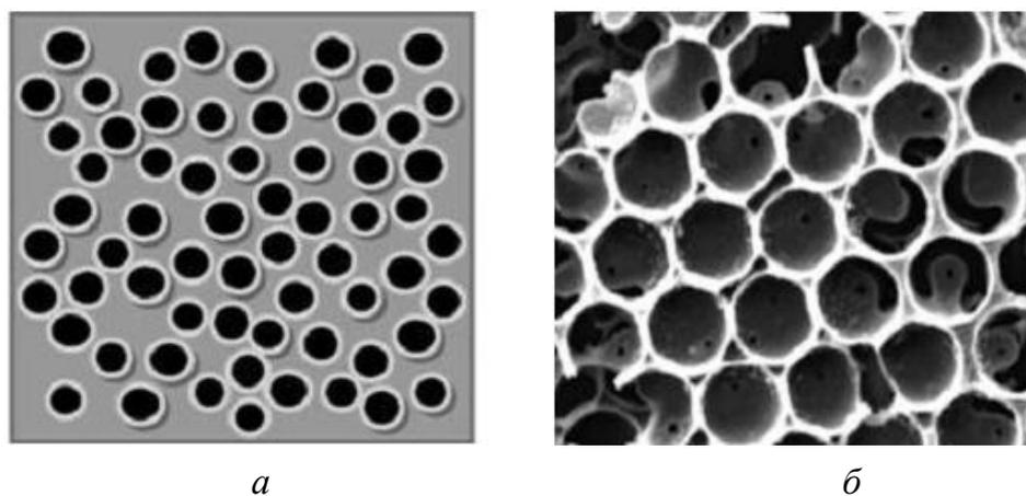
Рисунок 8.4 – Схема распределения пор в наноматериале (а) и микрофотография керамической наномембраны (б)
