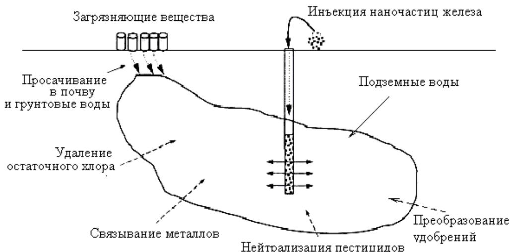
Рисунок 8.17 – Схема очистки почвы наночастицами железа
