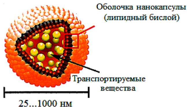
Рисунок 8.14 – Структура «наноконтейнера»
