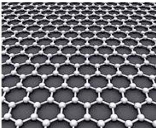
Рисунок 6.21 – Структура графена (расстояние между атомами 0,142 нм)
