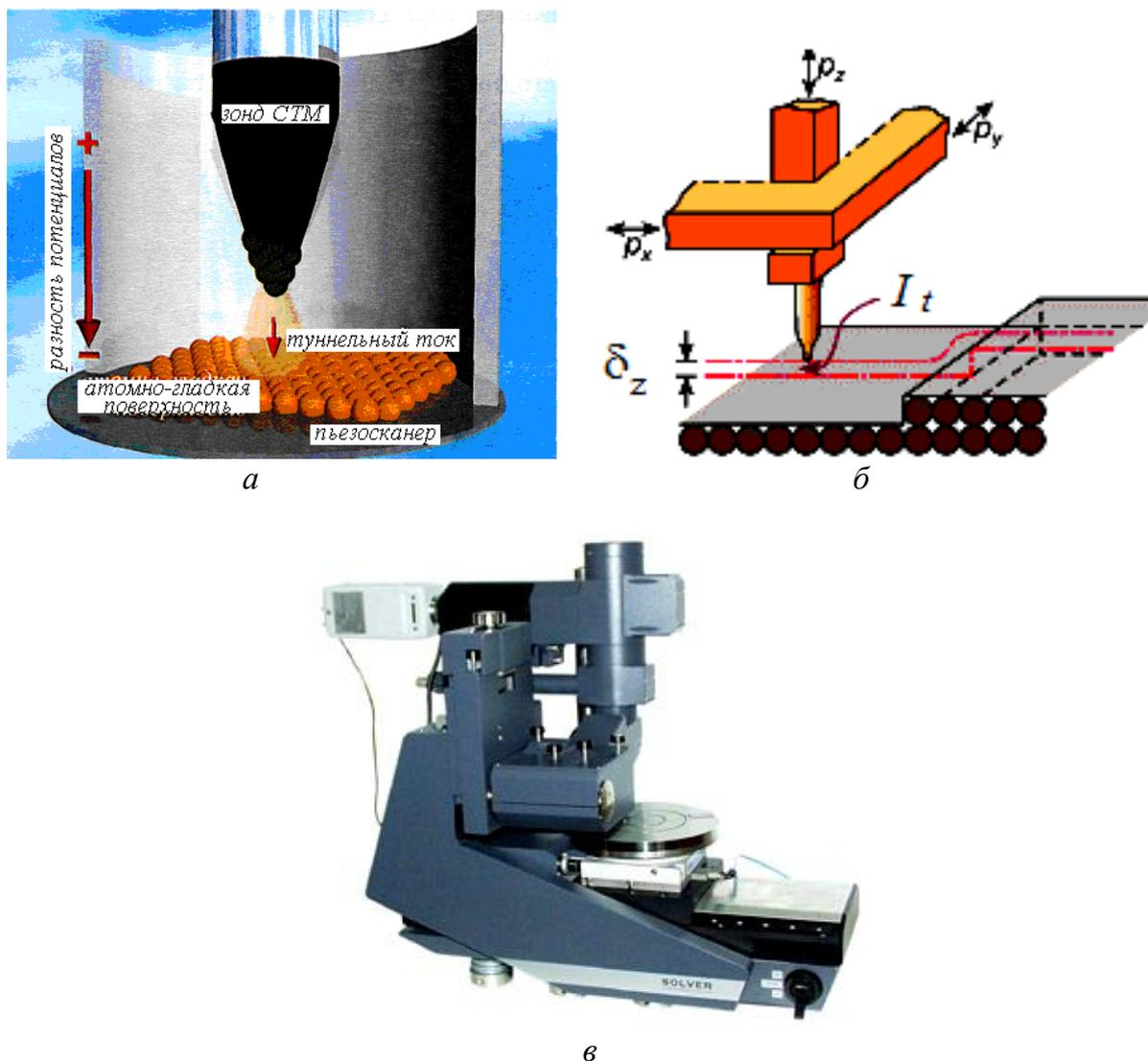
Рисунок 2.6 – Принцип реализации сканирующей туннельной микроскопии:
