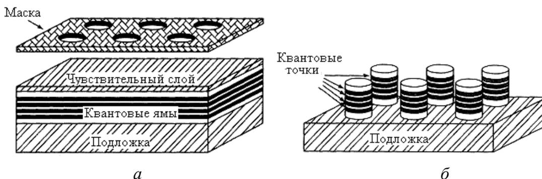
Рисунок 3.20 – Формирование массива квантовых точек методом литографии:
