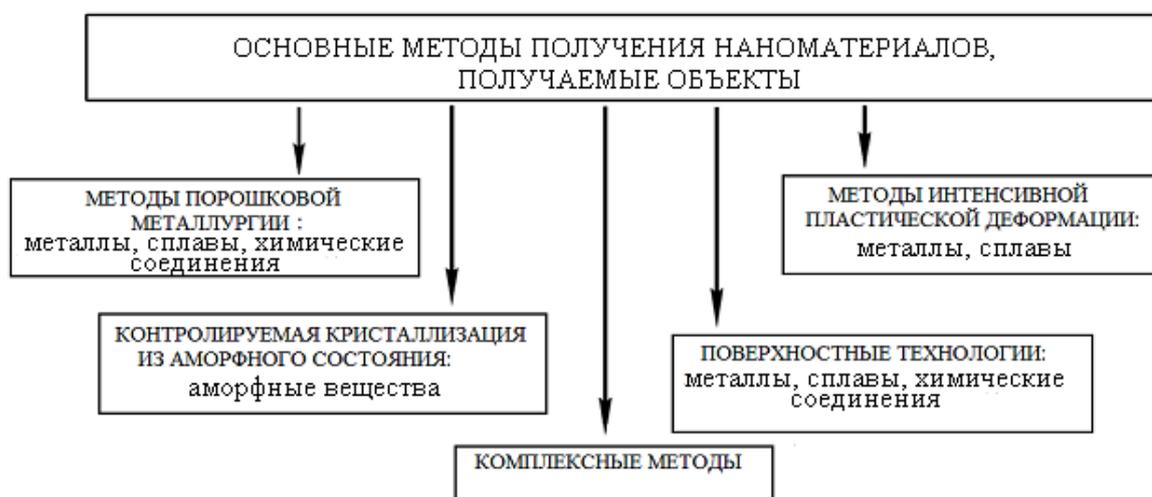
Рисунок 7.1 – Основные методы получения объемных нанокристаллических материалов
