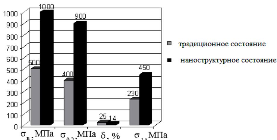
Рисунок 4.10 – Механические свойства технического чистого титана с традиционной структурой и в наносостоянии
