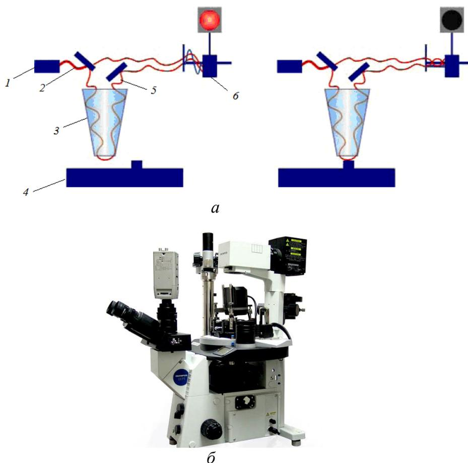
Рисунок 2.10 – Принцип работы СОМБП (а) и общий вид (б) сканирующего оптического микроскопа ближнего поля:
