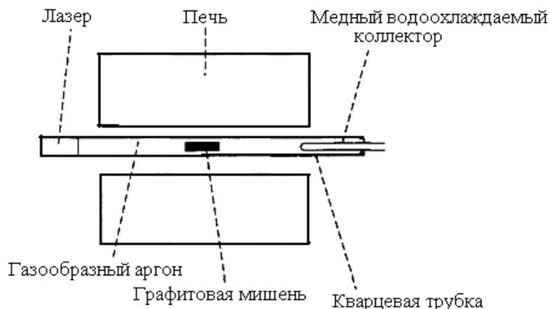
Рисунок 6.14 – Установка для синтеза углеродных нанотрубок лазерным испарением
