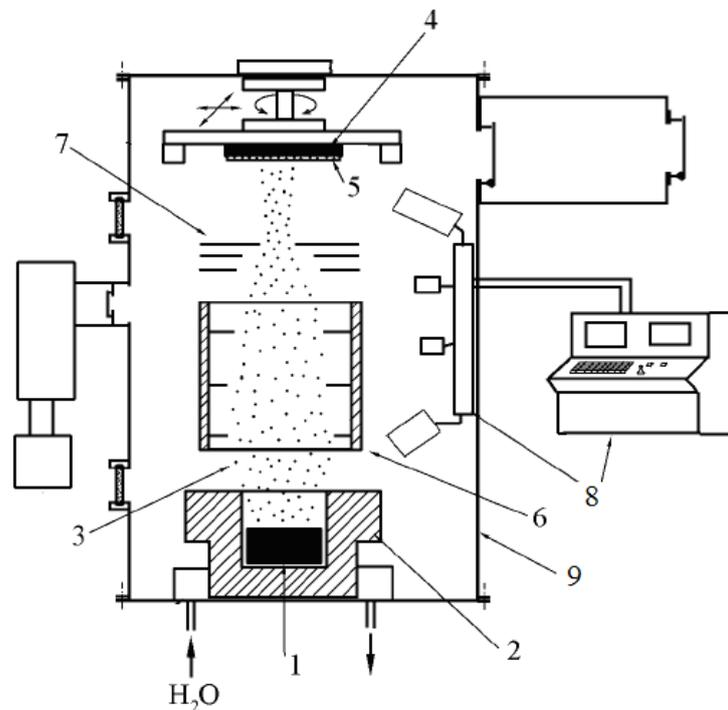
Рисунок 7.13 – Типичная схема установки для нанесения покрытия *PVD*-методом:
