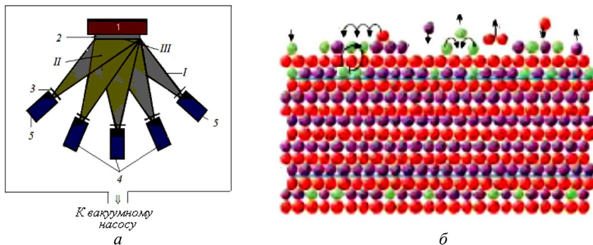
Рисунок 3.14 – Схема установки молекулярно-лучевой эпитаксии (а) и схема роста пленки путем «атомной укладки» (б):
