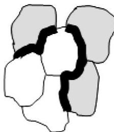
Рисунок 7.7 – Перемещение зерен относительно друг друга за счет проскальзывания по границам
