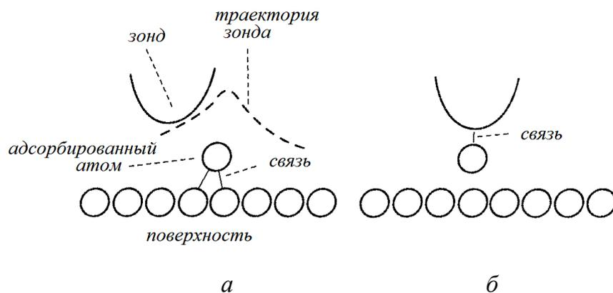
Рисунок 3.4 – Иллюстрация траектории острия зонда СТМ над адсорбированным на поверхности материала атомом:
