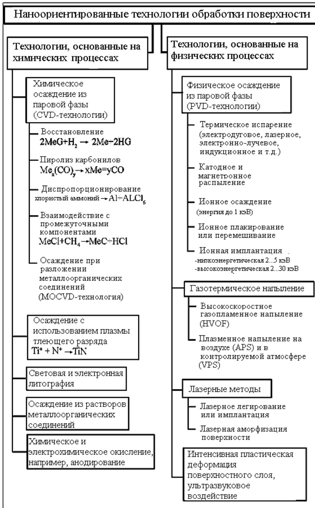
Рисунок 7.12 – Классификация наноориентированных технологий обработки поверхности
