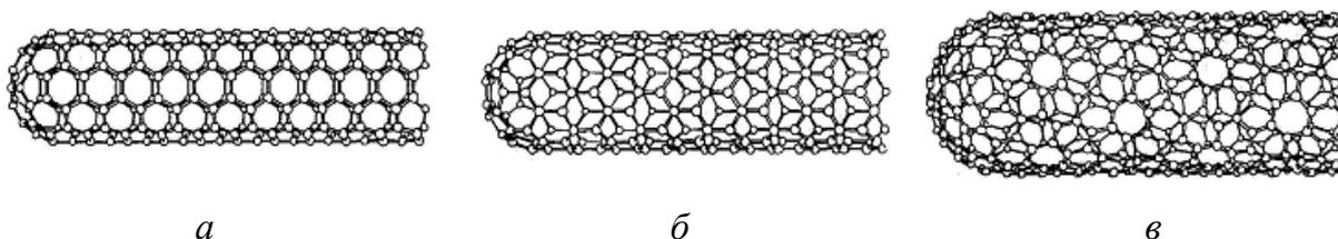
Рисунок 6.12 – Примеры некоторых возможных структур углеродных нанотрубок, зависящих от способа сворачивания графитового листа:  $a$  – кресельная структура;  $b$  – зигзагообразная структура,  $v$  – хиральная (спиралевидная) структура
